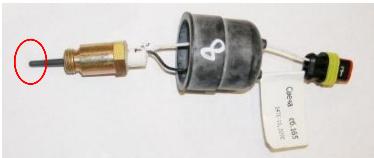
Оригинальная свеча Сб.165 с элементом накаливания производства Китай
